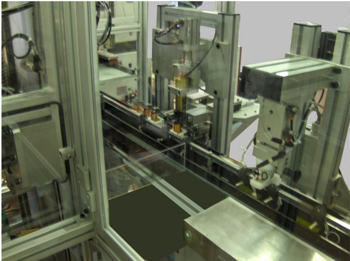
La stazione successiva è quella di saldatura con tecnologia inverter. Durante l'operazione il controllo provvede a selezionare l'eventuale scarto che verrà scaricato prima della posa della bobina nelle cassette.
