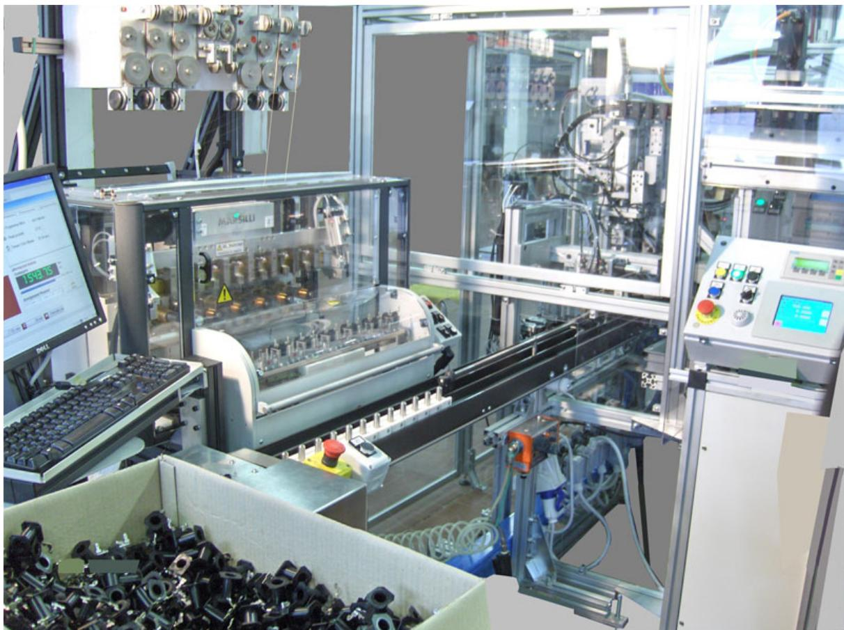
L'operatore carica i 6 rochetti sulla bobinatrice e scarica le bobine avvolte posizionandole sui palletts mobili della linea.
