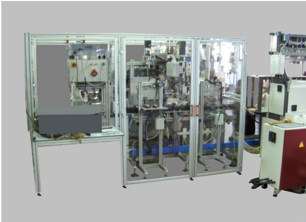
La linea così composta: BOBINATRICE, STAZIONI DI PIEGA, STAZIONE DI SALDATURA, STAZIONE DI CONTROLLO E STAZIONE DI SCARICO è lunga circa 5 mt e larga 2.
